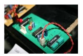
SpeakJet-IIC-Module Breadboard v1.3
